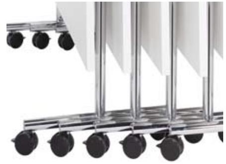
T-Fuß aus Rundrohr  $\varnothing$  40 x 2 mm mit Stabilisierungszarge R60 x 20 x 2 mm fest verschraubt, serienmäßig schwarz pulverbeschichtet, wahlweise nach BRUNE-Kollektion oder verchromt. Die Tischfußausleger sind mit vier feststellbaren Rollen versehen. Durch eine einhandbedienbare Auslösetaste kann die Tischplatte horizontal um 90° geklappt werden.
