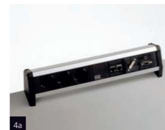
4a E-Schiene über Platte, lang Bestückt mit 1 6-fach Steckdose, 3 x Schuko fest und 3 x frei wählbar mit Medientechnikmodulen, hier 2 x RJ-45 CAT5E-Anschluss für LAN-Verbindungen, DVI-Anschluss (digital) mit Miniklinke BCM-14A, VGA-Anschluss (analog) mit Miniklinke BCM-4K.
